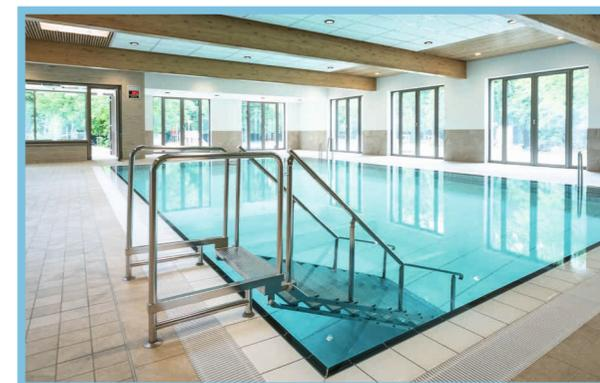
Durch den verstellbaren Hubboden im Multifunktionsbecken kann die Wassertiefe je nach Nutzergruppe eingestellt werden.
